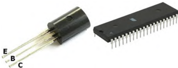
Fig. 2.16 Transistor ( left ), IC ( right )
